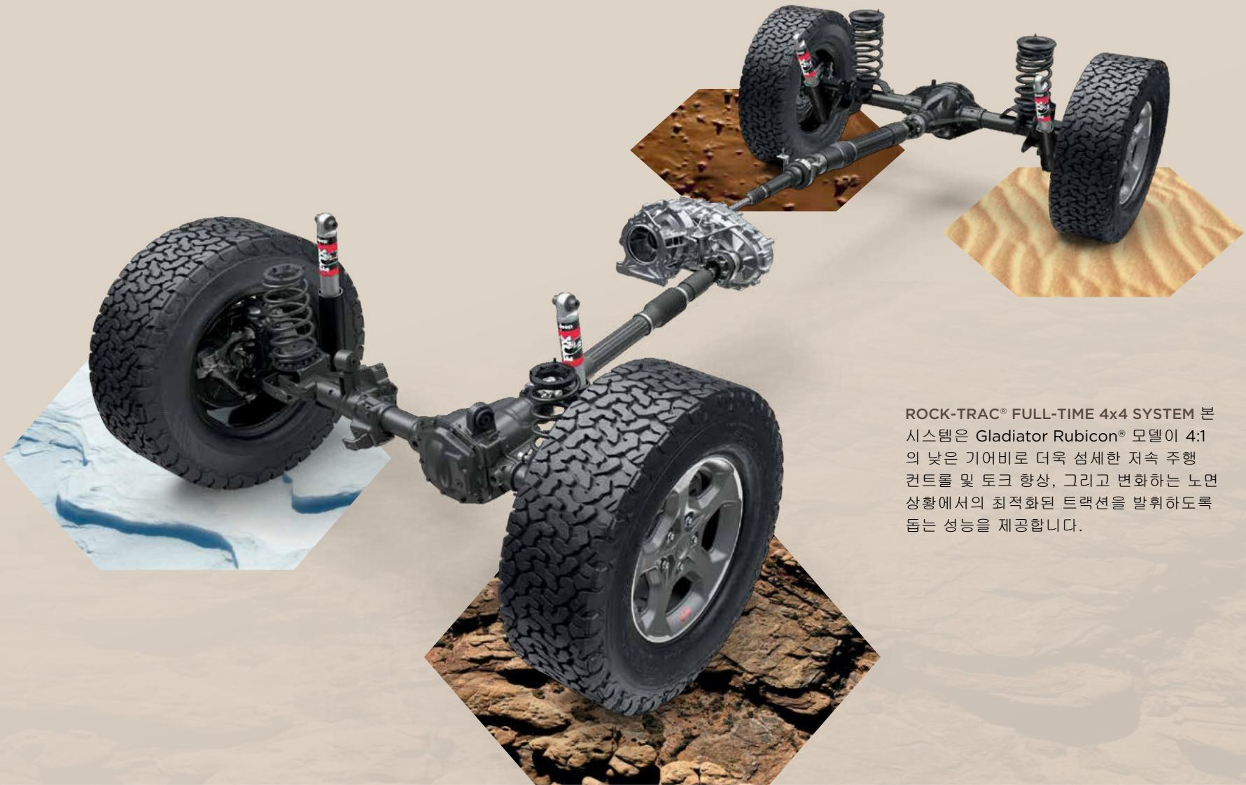
ROCK-TRAC® FULL-TIME 4x4 SYSTEM 본 시스템은 Gladiator Rubicon® 모델이 4:1 의 낮은 기어비로 더욱 섬세한 저속 주행 컨트롤 및 토크 향상, 그리고 변화하는 노면 상황에서의 최적화된 트랙션을 발휘하도록 돋는 성능을 제공합니다.
