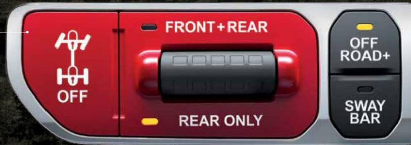
**OFF-ROAD+** 버튼을 누르면 현재 Jeep® Gladiator가 달리고 있는 지형을 자동 분석해 스포를, 셀렉-스피드 컨트롤, 트랙션 제어, 변속기 모드 등 주요 시스템 조정을 통해 주행을 최적화합니다. 4-HI 모드에서 버튼을 누르면, 더욱 빠른 속도로 모래 주행이 가능하도록 변경됩니다. 4-LO 모드에서 버튼을 누르면, 저속의 앙반 주행에 적합하도록 변경됩니다.
