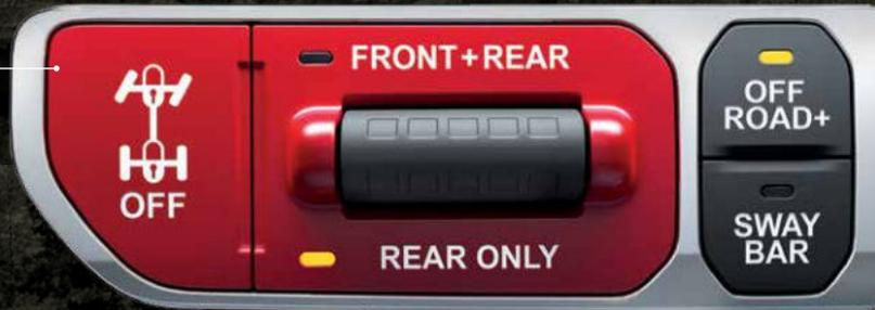
**OFF-ROAD+** 버튼을 누르면 현재 Jeep Gladiator가 달리고 있는 지형을 자동 분석해 스로틀, 섀클-스피드 컨트롤, 트랙션 제어, 변속기 모드 등 주요 시스템 조정을 통해 주행을 최적화합니다. 4-HI 모드에서 버튼을 누르면, 더욱 빠른 속도로 모래 주행이 가능하도록 변경됩니다. 4-LO 모드에서 버튼을 누르면, 저속의 암반 주행에 적합하도록 변경됩니다.
