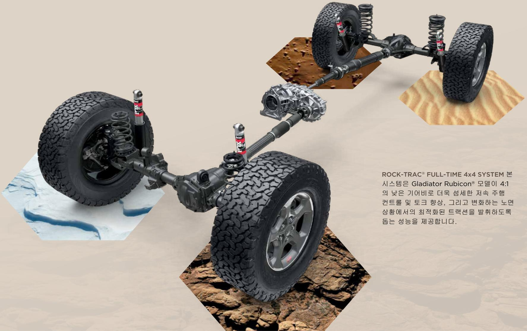
ROCK-TRAC® FULL-TIME 4x4 SYSTEM 본 시스템은 Gladiator Rubicon® 모델이 4:1의 낮은 기어비로 더욱 섬세한 저속 주행 컨트롤 및 토크 향상, 그리고 변화하는 노면 상황에서의 최적화된 트랙션을 발휘하도록 돕는 성능을 제공합니다.
