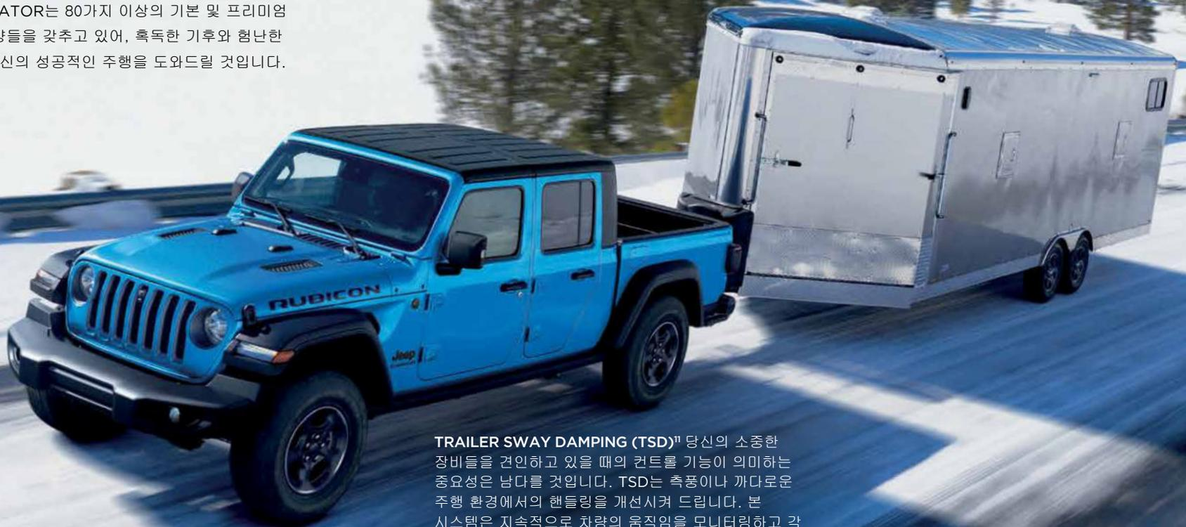
**TRAILER SWAY DAMPING (TSD)**<sup>1)</sup> 당신의 소중한 장비들을 견인하고 있을 때의 컨트롤 기능이 의미하는 중요성은 남다를 것입니다. TSD는 측풍이나 까다로운 주행 환경에서의 핸들링을 개선시켜 드립니다. 본 시스템은 지속적으로 차량의 움직임을 모니터링하고 각 휠의 제동 압력을 조절하여 차량이 안전하게 전진할 수 있도록 지원합니다.
